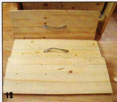
12 Перед установкой лицевых панелей предварительно в каждой просверлили отверстия под ручки...
