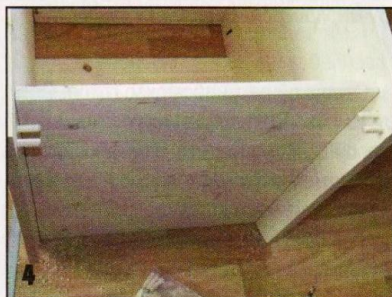
4 Панели цоколя крепил при помощи мебельных шкантов.
